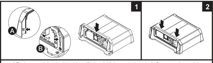
1. Encaixe a capa plástica rente à lateral do amplificador, coincidindo os pontos de encaixe A e B, e empurrando-a para baixo.
