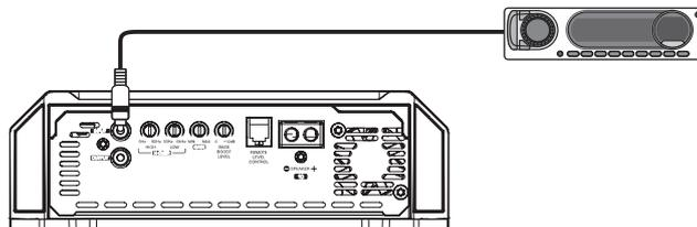
Ejemplo de conexión de dos cables RCA (entrada mono).
