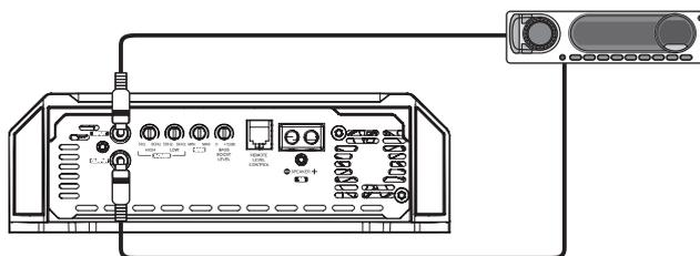
Ejemplo de solo una conexión de cable RCA y usando la salida RCA para conectar otro amplificador.
