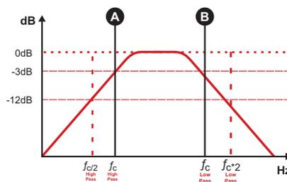
Establezca en el control variable "HIGH" entre 5Hz y 80Hz ("A") donde desea realizar el filtro de corte pasa alta;
